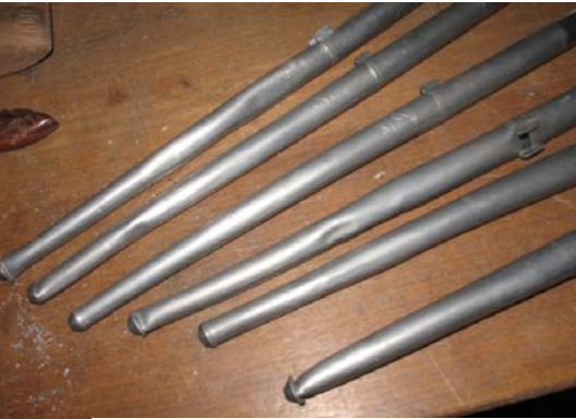
Pfeifen mit defekten Fußspitzen
